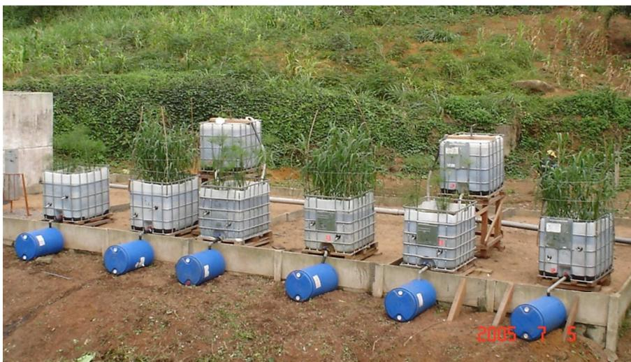
Photo 4 : Vue d'ensemble des pilotes de traitement des boues de vidange (Troesch, 2005)
