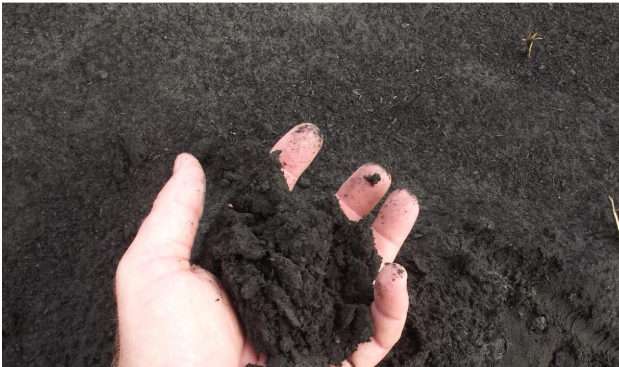
Figure 1. Photo de cendres humidifiées de la centrale de VOLTALIA Kourou. Crédit : SIMA-PECAT Guyane.
