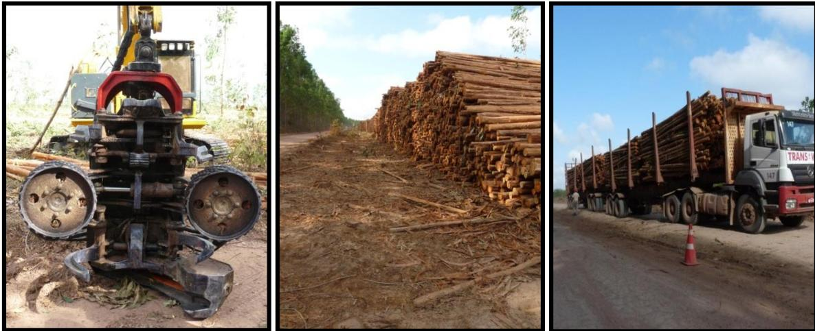
*Source : SIMA-PECAT & H2E – Exploitation à l'Abatteuse KOMATSU, empilage de bois bord de parcelle et transport sur route avec grumier attelé de 3 remorques avec ranchers.*
